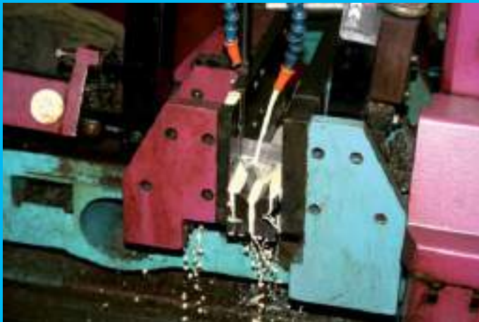
Corte de utillajes / Cutting of tools
