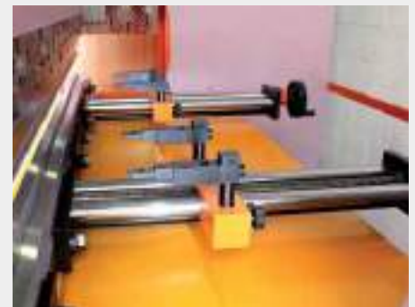
Vista del montaje de un brazo y de dos brazos (recomendable en plegadoras de más de 2 metros) View of the assembly of an arm and two arms (recommended in press brakes of more than 2 meters)
