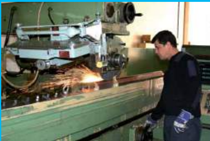
Rectificado de utillajes / Rectification of tooling
