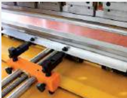
Opcional; barra de aluminio, con longitud de 750 m/m Optional. Aluminum bar with a length of 750 m/m
